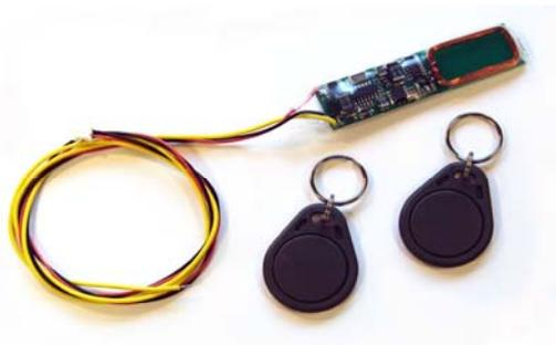
4. RFID- считыватель и RFID- брелоки
