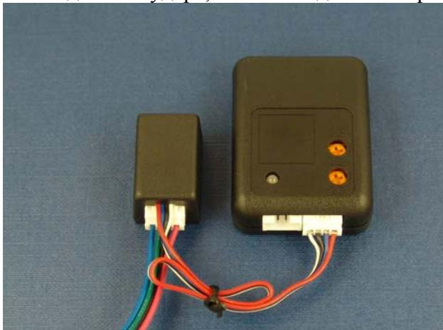
Логически выходы предупреждения и тревоги датчика Spider TMS2 будет работать параллельно с выходом предупреждения и тревоги 2-уровневого датчика системы.
