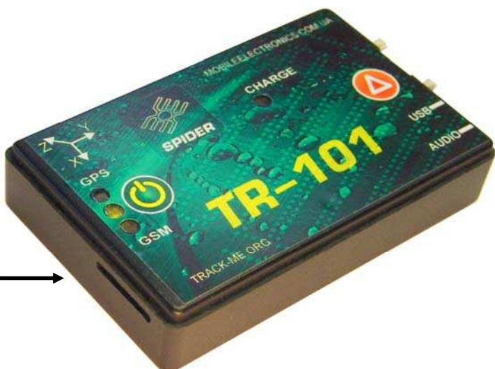
При необходимости извлечь SIM-карту – снова толкните её вглубь трекера до щелчка. Картоприёмник вытолкнет её автоматически.
