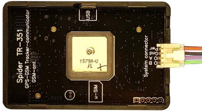
GPS-трекер Spider TR-351 (с открытой крышкой). Системный разъем находится в торце корпуса
